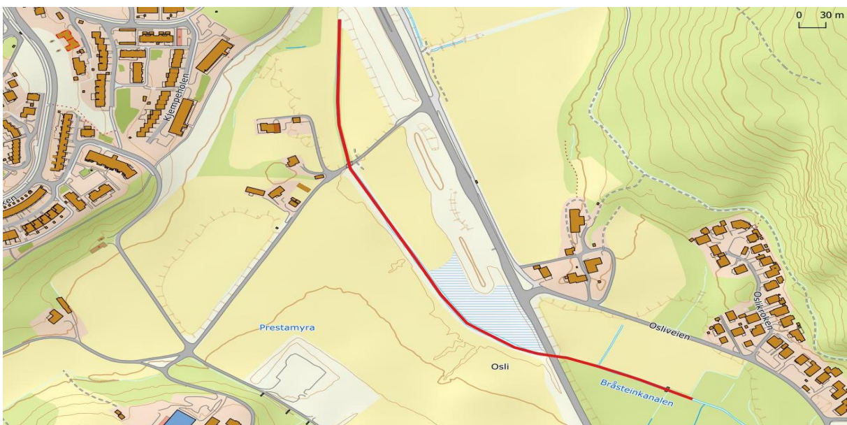
Figur 5.47. I Bråsteinkanalen er det en strekning på over 700 meter som har svært dårlige kvaliteter for fisk. Større restaureringstiltak der løpet i større eller mindre grad legges om kan trolig gi bedre resultat enn tiltak der eksisterende kanaliserte løp beholdes. Dette vil imidlertid kreve at elva får litt mer plass enn i dag.
