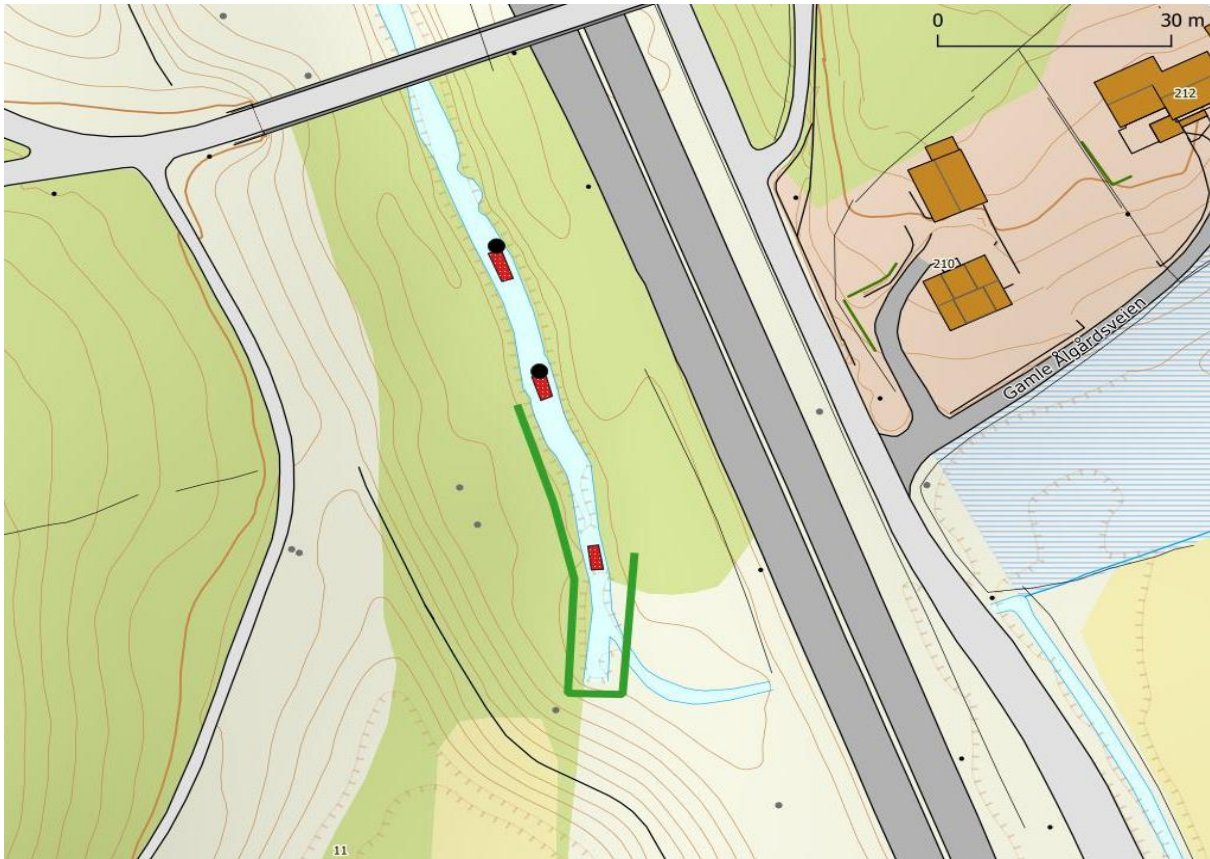
Figur 5.44. Det bør plantes til med funksjonell kantvegetasjon i form av svartor og vierarter langs den 70 meter lange sona (grønn). Det bør suppleres med gytegrus ved de to eksisterende gyteområdene (svarte punkter), og legges ut gytegrus i et nytt felt litt lenger oppstrøms. Det bør brukes laksegrus på nedre felt og sjøørretgrus eller blanding på de to øvre feltene. Utlegging av noe habitatstein umiddelbart rundt gytegrusen er aktuelt.
