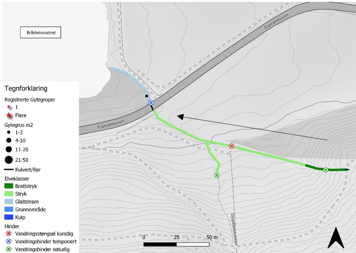
Figur 10.2: Elveklasser, gytegrus og ulike inngrep i Djupedalsbekken. Elveklassene består av glattstrøm, lett stryk og bratt stryk, hvor bratt helling, store steiner og mangel på spranggroper utgjør et vandringsstengsel for anadrom fisk. Strykpartiet består av store andeler stein og blokk. Grov grus finnes kun spredt i strykpartiet. Tilslammert gytegrus i varierende størrelse ble kun funnet nedstrøms veien.
