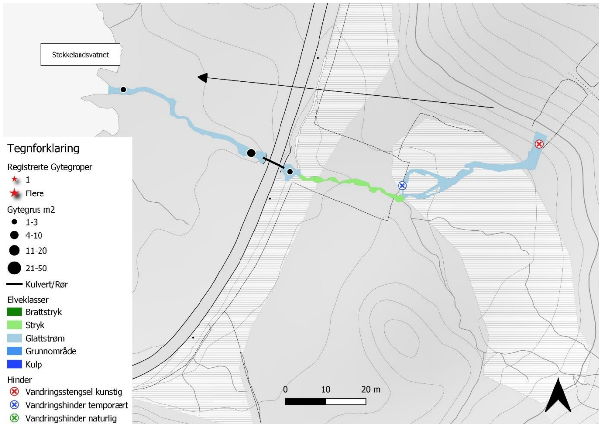
Figur 8.6: Elveklasser, gytegrus og ulike inngrep i Djupedalsbekken. Bekken består hovedsakelig av glattstrøm, knyttet i sammen av et smalt strekk med stryk. Store deler av øverste sone ligger tørt ved lav vannføring. Hele bekken har mye grus, men gytearealer finnes kun i nedre deler av bekken. Det ligger grov grus i bekkens svinger i nedre parti, som ellers domineres av sand. Gytegrusen nedstrøms turstien bærer preg av noe tilslamming. Det største arealet med gytegrus strekker seg nedstrøms i et smalt belte fra markert punkt. Det er litt erosjonssikring av kanter i forbindelse med rør ved tursti, samt i selve utløpsområdet ved vandringsstengsel. Dette er ikke vist i kartet.
